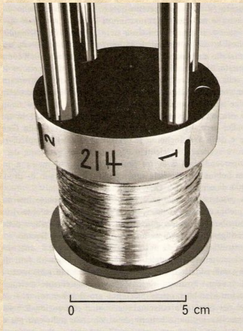
Un piccolo magnete superconduttore in grado di produrre un intensissimo campo magnetico pari a 100.000 oersted
