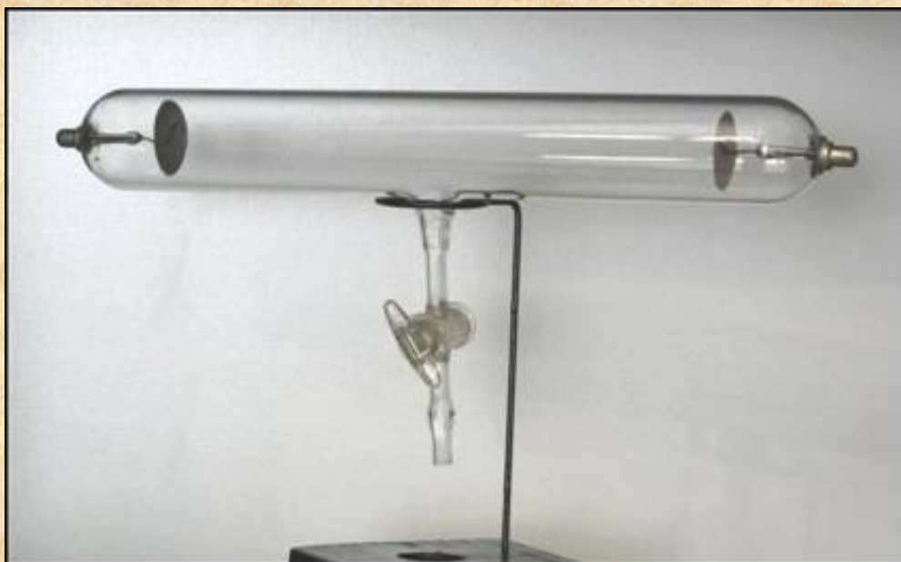
Un tubo di Hittorf. Il rocchetto si collegava alle due estremità mentre in basso si collegava la pompa da vuoto.
